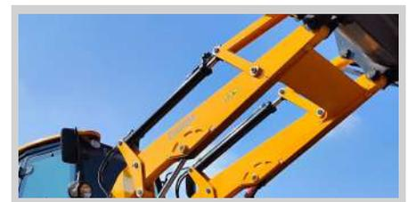
Pala con Diseño de Doble Cilindro
